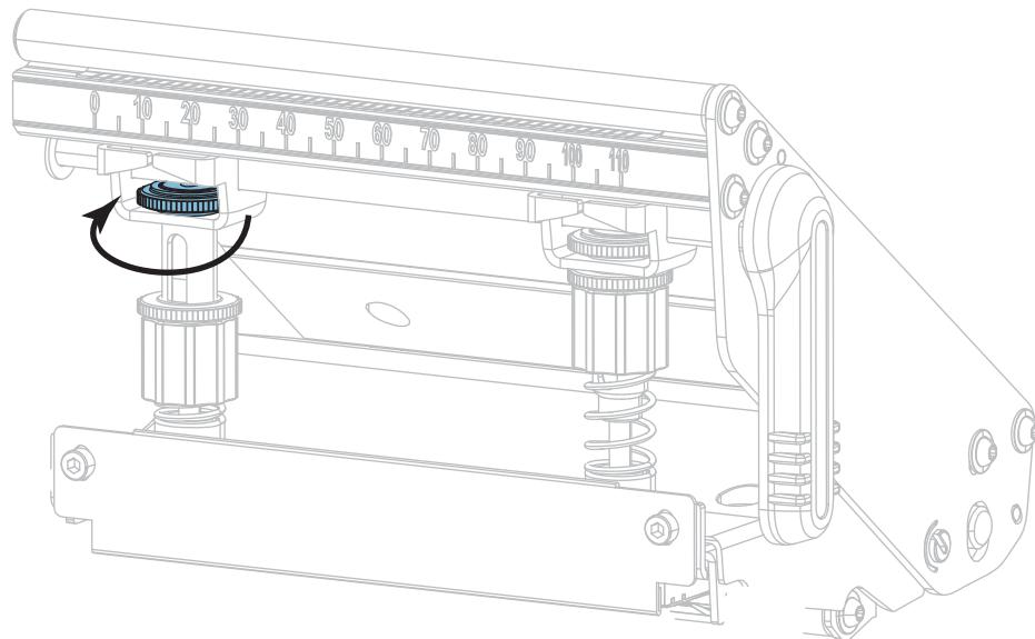
3. Передвиньте подпружиненные упоры, пока они не будут оказывать равномерное давление на носитель. Если используется слишком узкий носитель, расположите внутренний подпружиненный упор по центру носителя и уменьшите давление на внешний упор.
