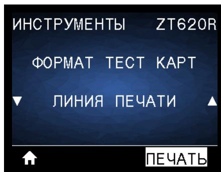
Принтер инициирует последовательность тестов, в ходе которой с разными скоростями печатается несколько изображений для проверки чернил и печатающей головки. Эти тестовые этикетки можно использовать при выполнении регулировки механических узлов принтера или для выявления неработающих элементов печатающей головки.
