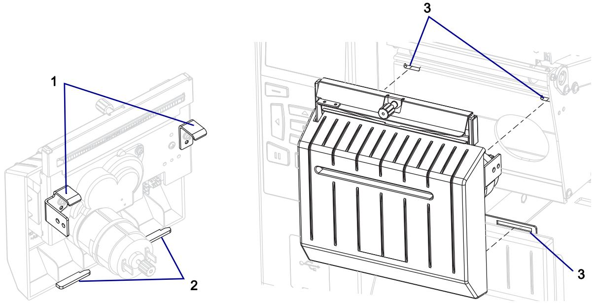
8-ф. Сдвиньте модуль резака влево и вверните крепежный винт.
