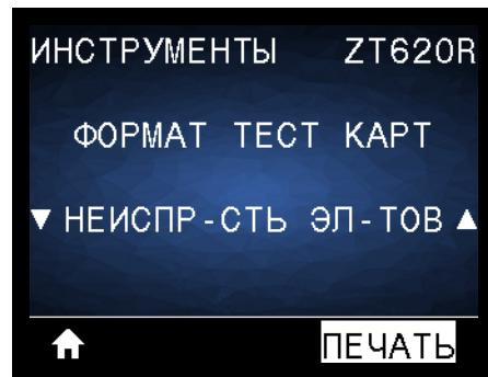
Принтер печатает горизонтальное изображение, позволяющее определить неисправные элементы печатающей головки.
