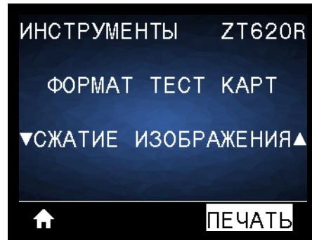
Принтер печатает изображение с равномерно распределенными по краям изображения диагональными линиями, окружностями и знаками решетки, которое можно использовать для устранения неполадок со сжатием или растяжением изображения. Для оценки наличия искажений можно измерить расстояние между знаками решетки или сравнить размеры окружностей и линий.
