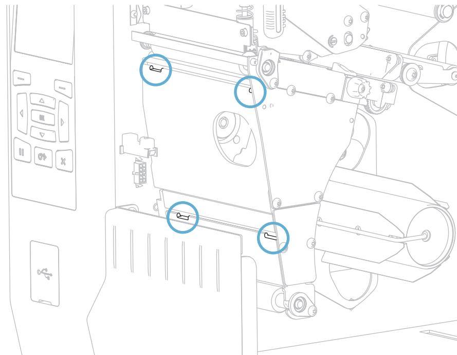
2. Найдите четыре монтажных ушка на пластине перемотки/наматывания подложки.
