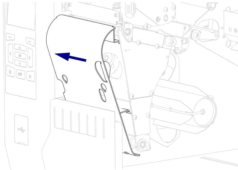
**3.** Сдвиньте катушку на шпиндель перемотки, чтобы она оказалась на одном уровне с направляющей пластиной.
