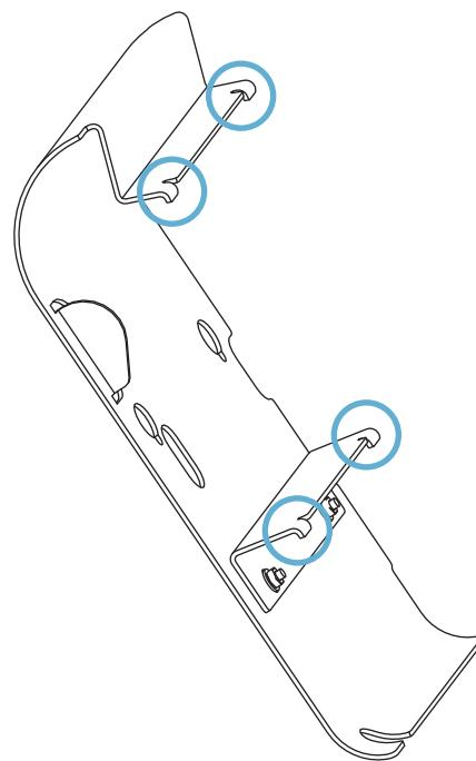
**2-с.** Вставьте ушки пластины перемотки в монтажные пазы принтера, после чего сдвиньте пластина влево до упора.
