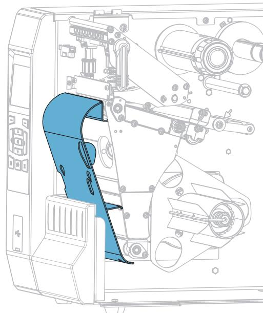
**2-а.** Найдите четыре монтажных паза на принтере для этой пластины.
