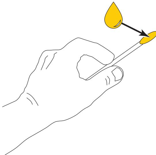
11. Нанесите смазку ровным слоем на все открытые поверхности обоих лезвий. Удалите излишки смазки, чтобы исключить ее попадание на печатающую головку или опорный валик.
