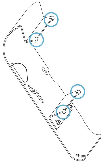
3. Вставьте ушки пластины перемотки в монтажные пазы принтера, после чего сдвиньте пластины влево до упора.
