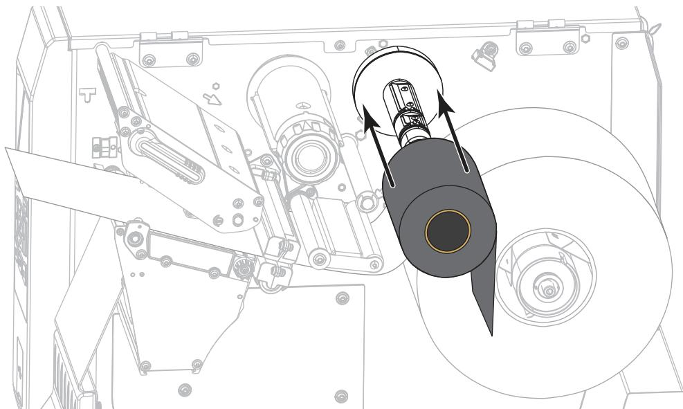
4. Протяните ленту под узлом печатающей головки и вокруг его левой стороны, как показано.
