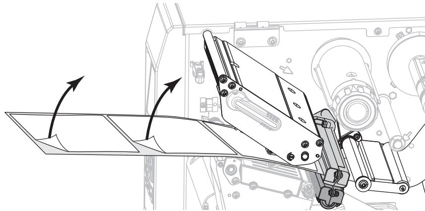
5. Затяните носитель обратно в принтер таким образом, чтобы над зеленым индикатором в нижней части датчика носителя располагалась только подложка.
