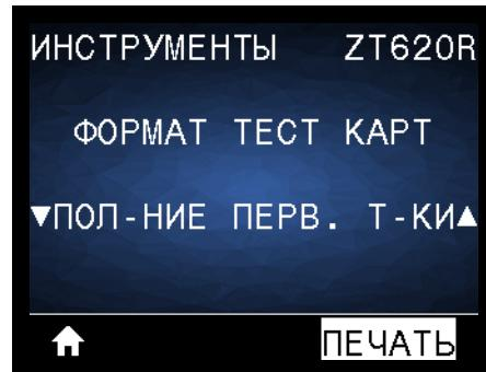
Принтер печатает изображение, с помощью которого можно при необходимости скорректировать положение изображения на этикетках. На изображении печатаются линии, определяющие верхний левый угол этикетки.
