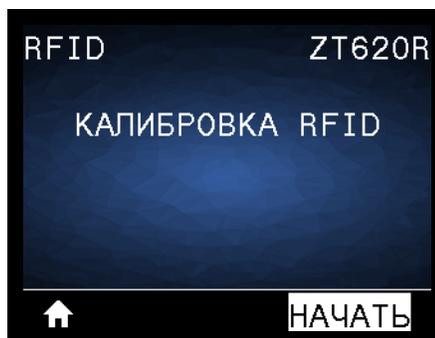
Инициирование калибровки метки для RFID-носителя. (Отличается от калибровки носителя и ленты.) В ходе этой операции принтер перемещает носитель, калибрует положение RFID-метки и определяет оптимальные параметры для используемого носителя RFID. Эти настройки определяют значения программного позиционирования, используемый антенный элемент и уровень мощности чтения/записи. Дополнительные сведения см. в *Руководстве по программированию RFID 3*.
