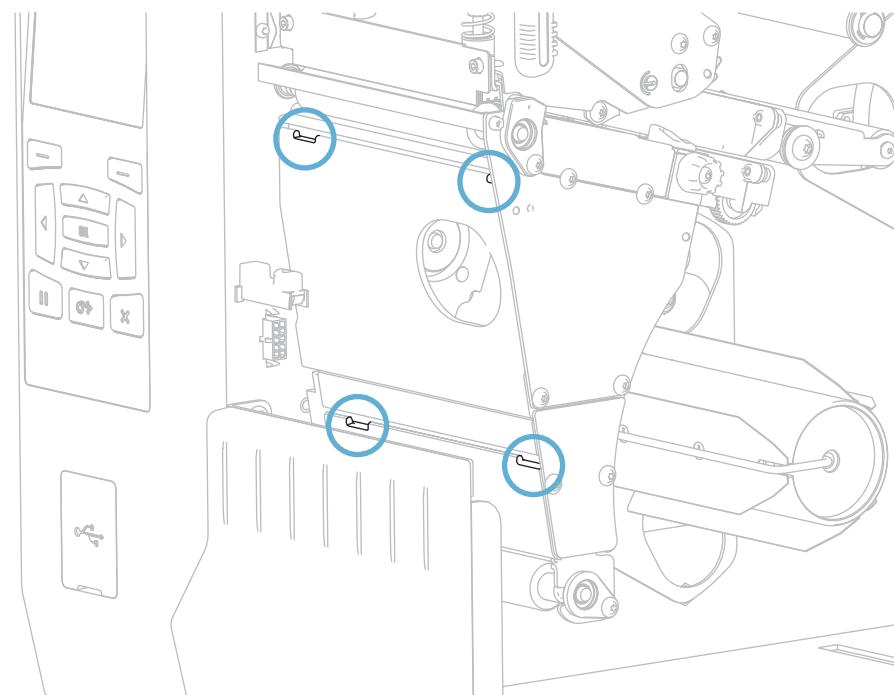
**2-б.** Найдите четыре монтажных ушка на пластине перемотки/наматывания подложки.
