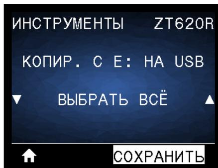
С помощью параметра **ВЫБРАТЬ ВСЁ** можно сохранить все доступные файлы с принтера на флеш-диске USB. Любой скопированный ZPL-файл проходит последующую обработку, чтобы его содержимое можно было отправить на принтер для нормального выполнения.
