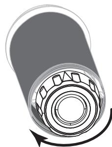
Толкатели фиксатора ленты повернутся вниз, освобождая зажатую шпинделем использованную ленту.
