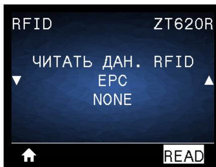
Чтение и возврат определенных данных из RFID-метки, помещенной над антенной RFID. При чтении данных метки не происходит никаких перемещений в принтере. Печатающая головка может быть открыта или закрыта.
