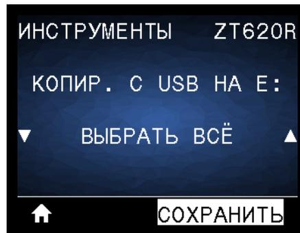
Принтер загрузит и обработает исполняемые файлы. Все доступные файлы будут включены в список. С помощью элемента **ВЫБРАТЬ ВСЁ** можно скопировать все файлы, доступные на флеш-диске USB.
