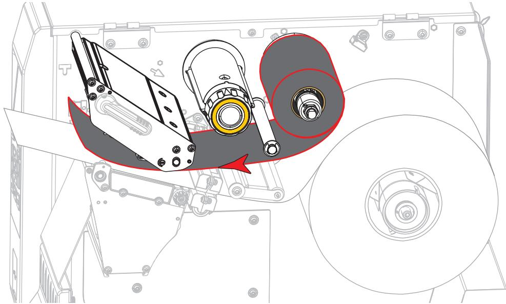
5. Протяните ленту под узлом печатающей головки до упора, а затем оберните ее вокруг приемного шпинделя ленты. Поверните шпиндель на несколько оборотов в показанном направлении, чтобы натянуть и выровнять ленту.
