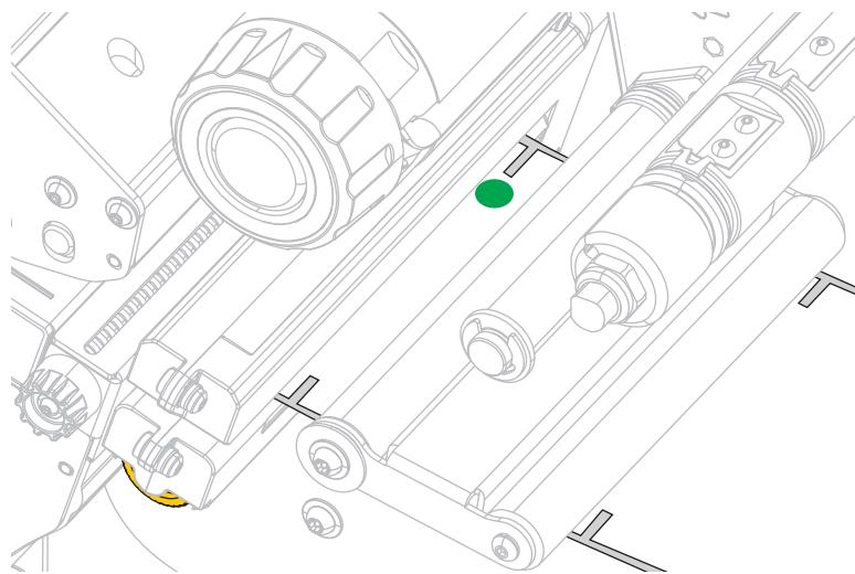
3. При необходимости поверните регулировочное колесико датчика, имеющее золотистый цвет, чтобы установить датчик непосредственно над просечкой или отверстием в носителе.
