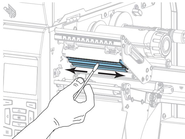
5. Проворачивая опорный валик вручную, тщательно очистите его тампоном. Дайте растворителю испариться.
